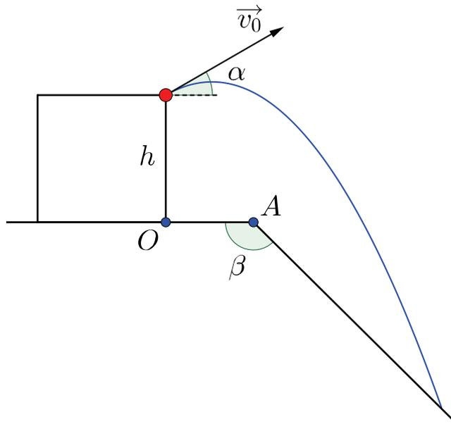
**Esercizio 3. (1,0 p.)** Un corpo viene lanciato orizzontalmente dalla quota  $h = 2 \text{ m}$ . Si determini la velocità iniziale in modo che l'angolo  $\delta$  di impatto con il suolo risulti uguale a  $45^\circ$ .
